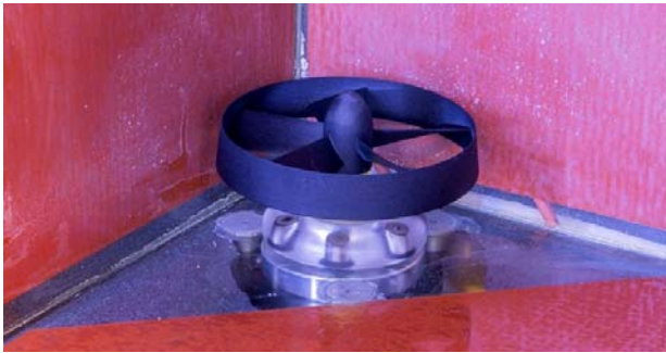
Kontaktløst magnetiske koblet blæserhjul
